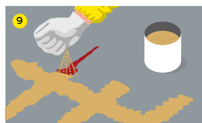
Saturação da fissura tratada com sílica sobre resina ainda em fresco para criação de ponte de aderência.
