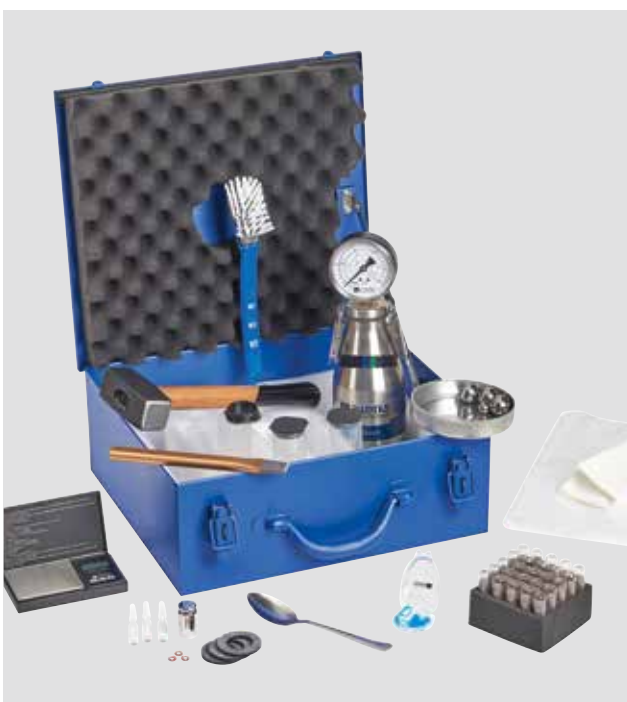
Fig. 09 | Kit para medição de humidade por método de Carboneto de Cálcio
