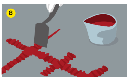
Preenchimento total da fissura e remoção de material excedente.
