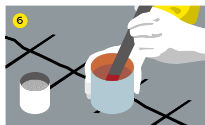
Mistura da resina epóxi com agregados de sílica.
